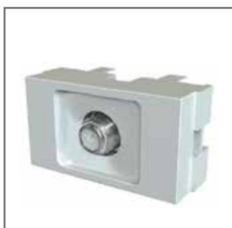
20209. MODULO TOMA T.V. CON ACOPLE ROSCADO PIN FINO 0 DB 75Ω.
